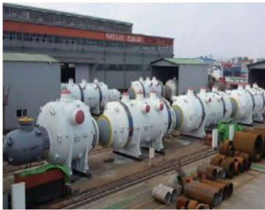
그림 139. 열교환기 Shell & Tube Heat Exchanger
