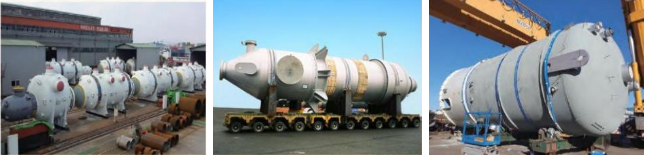
그림 7. 주요 장치 : 열교환기, 반응기, 압력용기
