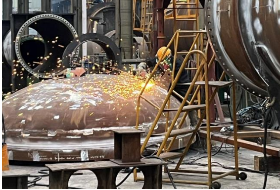
그림 1 열교환기 용접 과정
